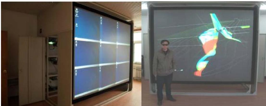
在立体显示墙上可视化飞行器外流场和压力等值面
